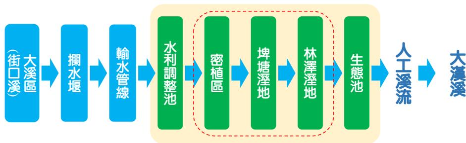
配置：採密植、開放、密植等三段式水平流人工濕地進行設計
